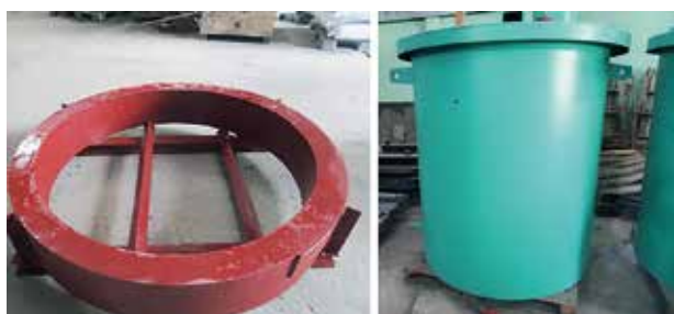
写真-4 ベトナムで製作した押輪（左）と丸タンク（右）
