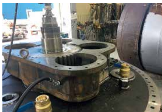
写真-9 隔壁部に取り付けられたギヤケース
