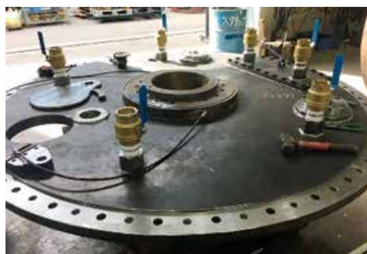
写真-8 駆動部が取り付けられる隔壁部材
